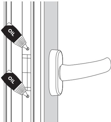
Das Beschlagsgetriebe muss einmal jährlich geölt werden.
